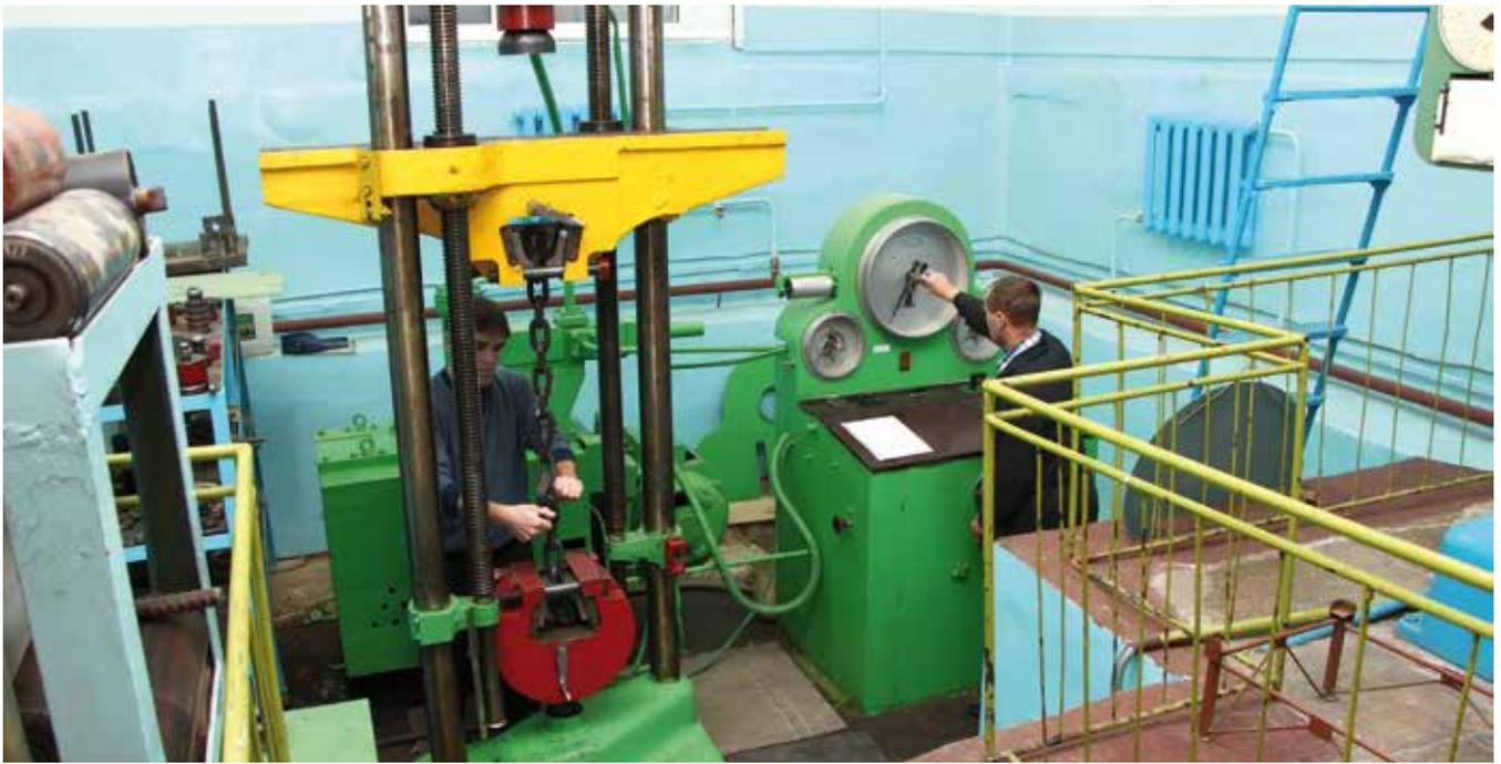
Испытание цепи скребкового конвейера
